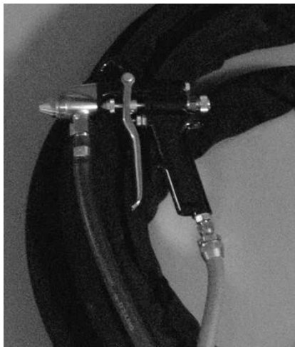
Fig. 2 Pistola con boquilla cónica y gatillo de resorte
