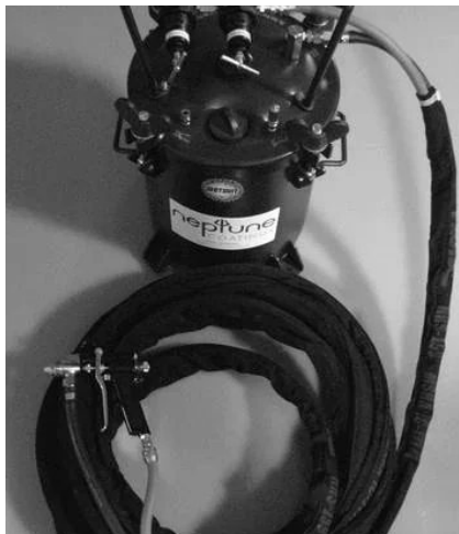
Fig. 1 Tanque de presión del equipo 17-500-WS1 con manguera encamisada
